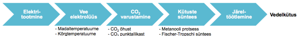
Joonis 4.1.2 Power-to-Liquid protsessi põhimõtteline skeem. Protsessi etappide all on välja toodud mõned võimalikud tehnoloogilised alternatiivid (madal- vs kõrgtemperatuurne elektrolüüs, CO 2 allikas, kütuste süntees läbi metanooli protsessi või Fischer-Tropschi sünteesi).
